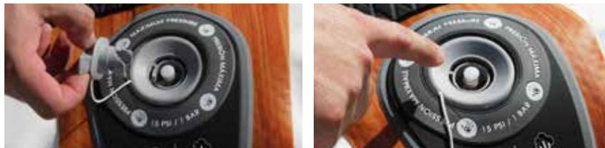
**ÉTAPE 4 :** Sortez la pompe, puis raccordez le tuyau à la poignée de la pompe. Assurez-vous que le tuyau est vissé correctement sur la poignée de la pompe.
